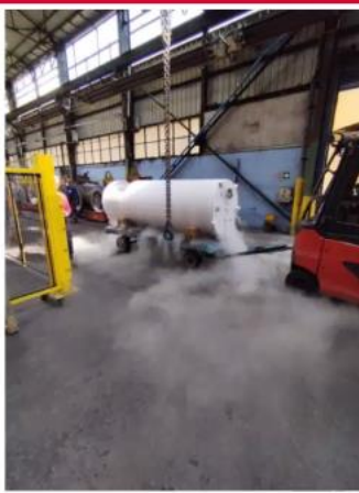
Piston après refroidissement à l'azote
