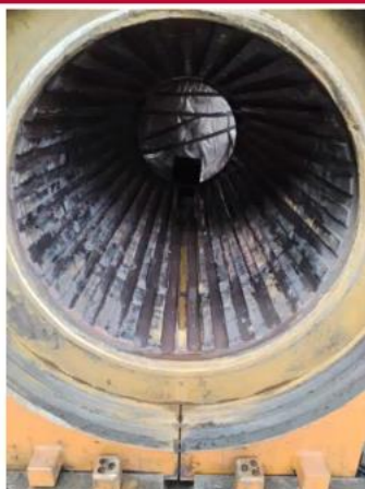
Usinage intérieur chambre
